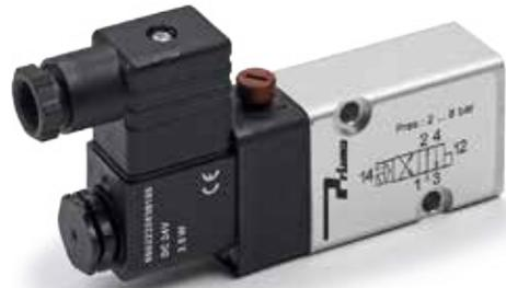
Magnetventil, wird mit dem Stellantrieb verbunden, um einen elektro-pneumatisch gesteuerten Kugelhahn zu bilden. Gleichstrom 24 V, 2,5 W 4/2 Wege für Doppelwirkung und Federrücklauf. Gehäuse IP65
